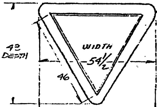
ALUMINUM EXTRUSION TO FORM RADIUSED CORNERS - ALL ALUMINUM WELDED CONSTRUCTION
